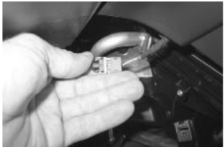
Kuva 5-2: Turvatyynyn pistokkeen irrotus
