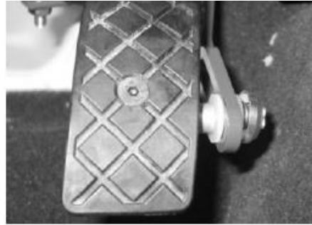
Kuva 5-62: Kaasun uravivun kiinnityskappale asennettuna
