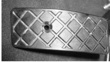
Kuva 5-6: Reiän poraaminen kaasupolkimen poljinlevyyn
