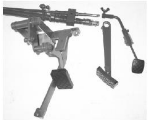
Kuva 5-36: Ajo-opettajan puoli purettu
