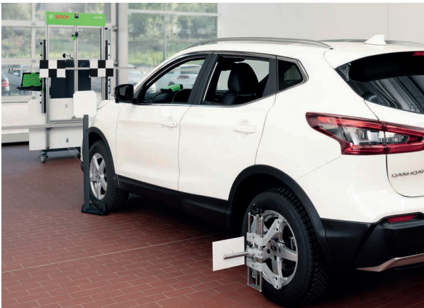
Nissan etututka + kamera: Ohjelmistopohjainen etäisyysmittaus näyttää kyvykkyytensä erityisesti 2-4 metrin etäisyyksillä. Se edistää korjaamon tehokkuutta. Etäisyysmittausavustin ja osoitin pyörän keskikohdan referenssille.
