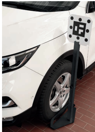
Nissan etututka + kamera: Ohjelmistopohjainen etäisyysmittaus näyttää kyvykkyytensä erityisesti 2-4 metrin etäisyyksillä. Se edistää korjaamon tehokkuutta. Etäisyysmittausavustin ja osoitin pyörän keskikohdan referenssille.
