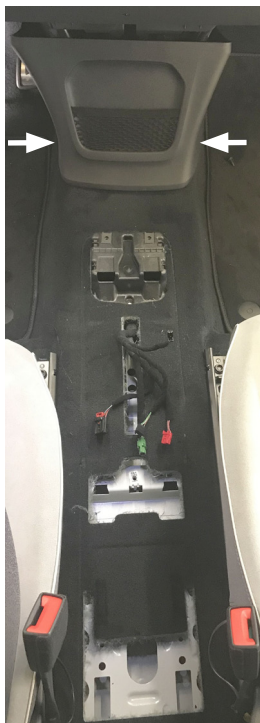
Kuva 4-18: Kojelaudan alaverhousosan irrotus
