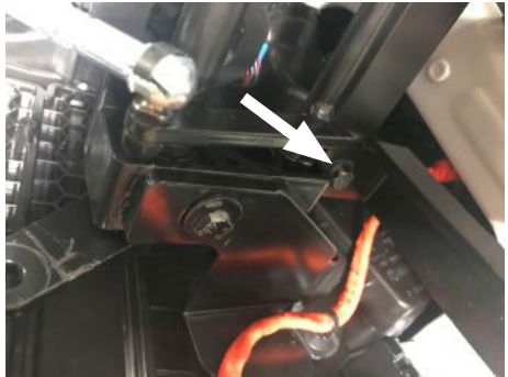
Kuva 4-50: Korkeajännitejohto etumatkustajan puolella
