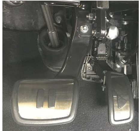
Kuva 4-43: Jarrun välityksen uravivun kiinnityskappale asennettu
