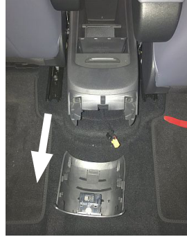
Kuva 4-15: Keskikonsolin takapään verhous
