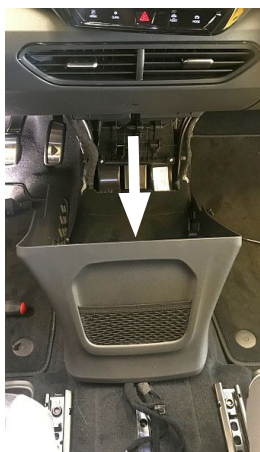
Kuva 4-19: Kojelaudan alaverhousosa irrotettu
