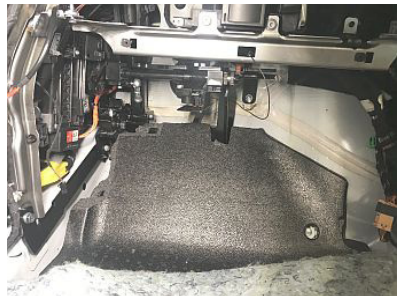
Kuva 4-22: Vaimennusosa etumatkustajan puolella
