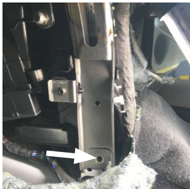
Kuva 4-30: Vasemman kiinnitystuen asennus
