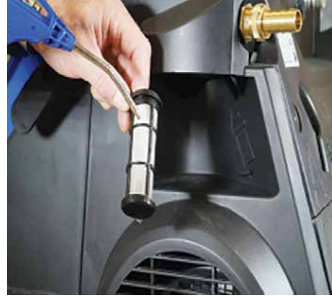
3. Puhalla suodatin paineilmalla tai huuhtele se vedellä.
