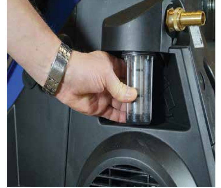
4. Asenna suodatinkotelo ja suodatin paikalleen.
