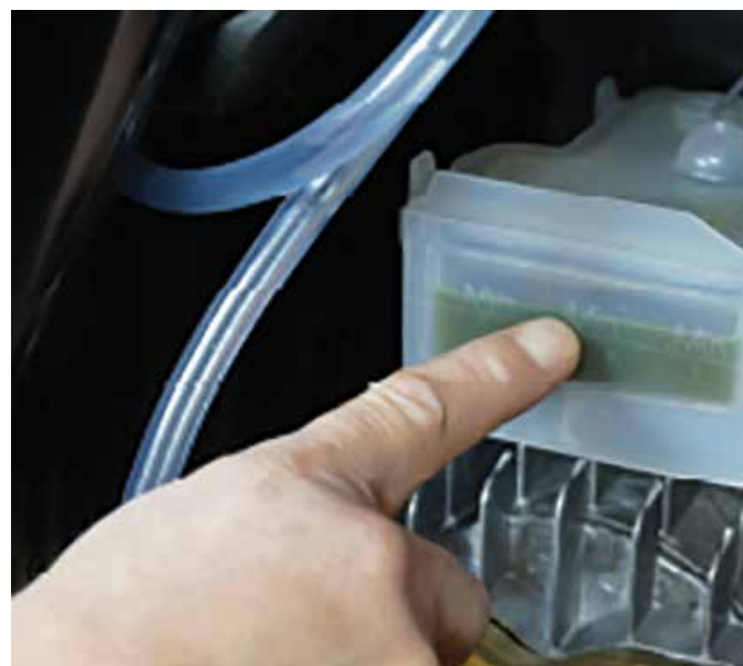
2. Öljytason on oltava minimimerkin yläpuolella.
