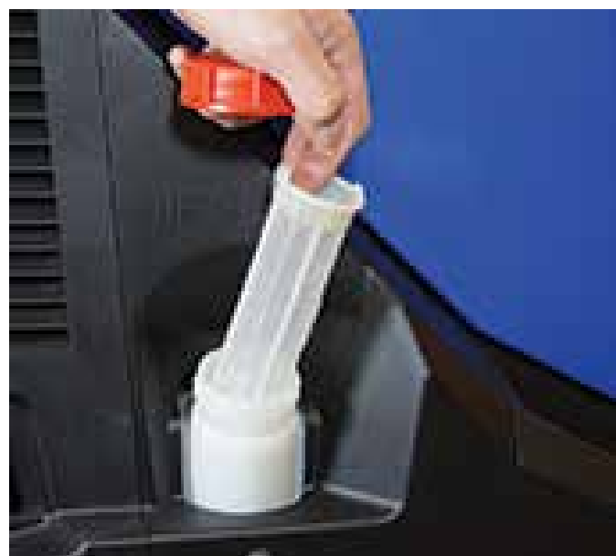
2. Vedä polttoainesuodatin ulos polttoainesäiliöstä.
