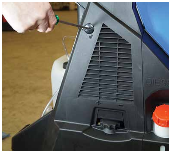
1. Avaa huoltoluukku kääntämällä neljänneskierroksia.
