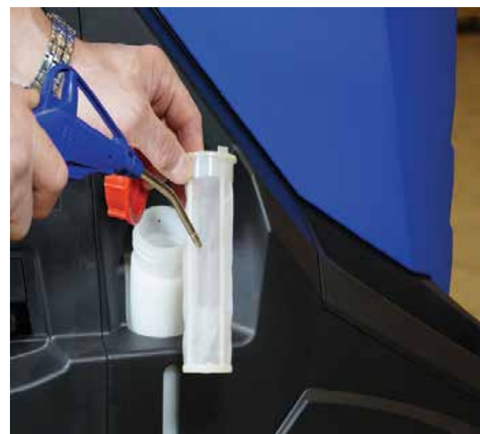
3. Puhalla polttoainesuodatin paineilmalla.
