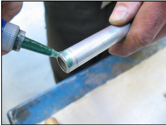
Lokprep tiivistysaine lisätään putkeen päähän.
