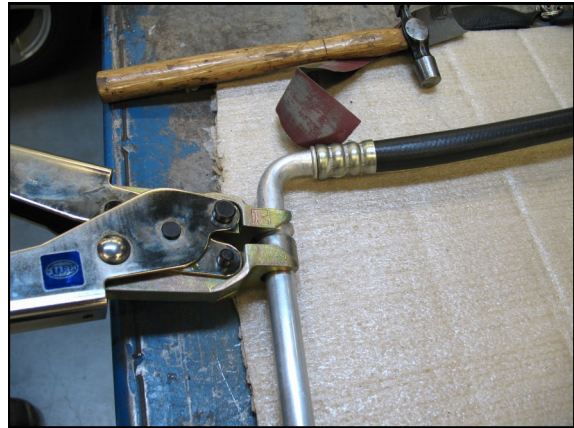
Liitos puristetaan Lokring asennuspihdeillä.
