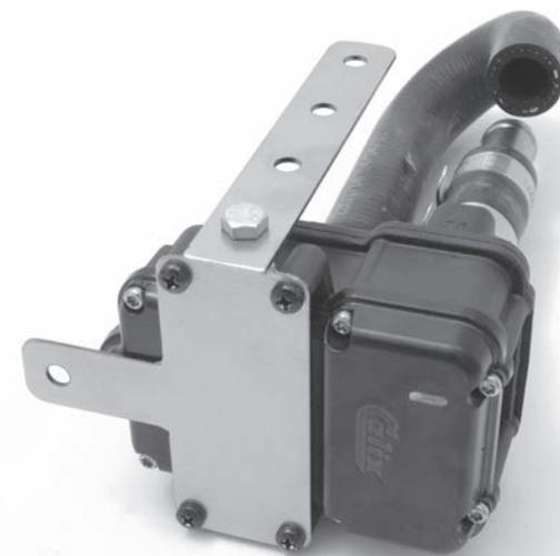
Fästet kan böckas och kapas för att anpassas till aktuellt fordon.
