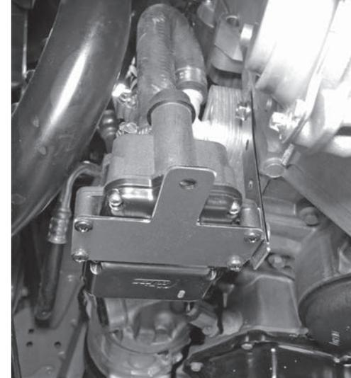
Exempel på hur FCH kan fästas i motorn med det medföljande fästet.
