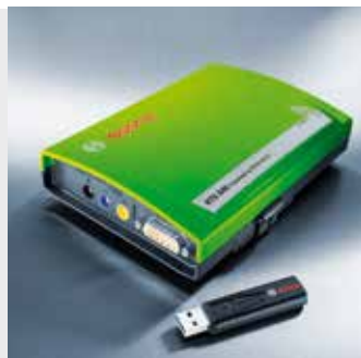
KTS 540 – Ohjainlaitediagnoosimoduuli 1-kanavaisella yleismitarilla Tilausnumero: 0 684 400 540
