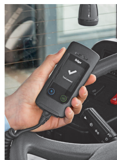
4. Hyväksyty puhallustesti: käynnistimen vapautus.
