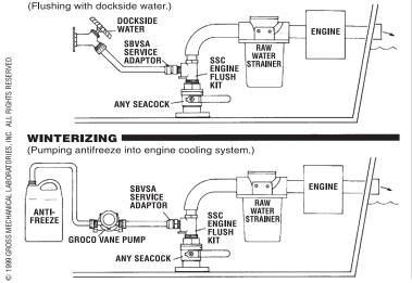
**ENGINE COOLING SYSTEM FLUSHING**
