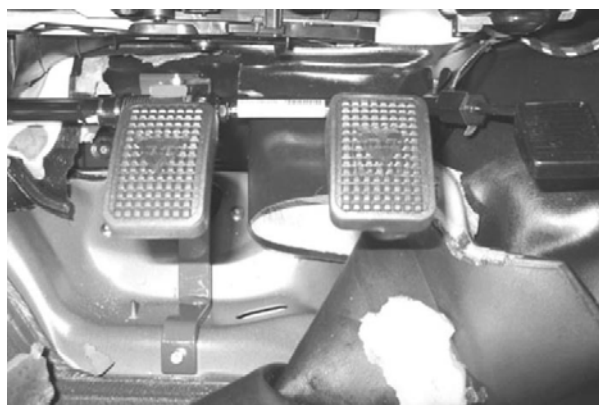
Kuva 5-32: Ajo-opettajan puoli asennettuna
