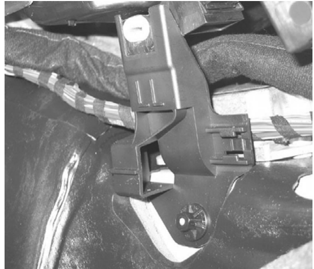
Kuva 5- 47 : Verhousosien kannattimien kiinnitys
