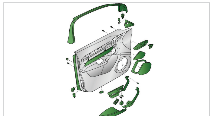
Oven verho: irrotus/asennus
