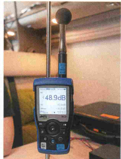
Wie laut die Klimaanlage arbeiten, ermittelte ein Geräuschmessgerät.
