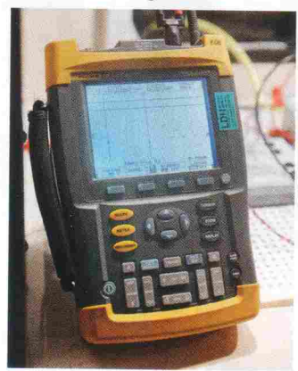
Mit dem Oszilloskop lassen sich ultrakurze Stromspitzen aufspüren.
