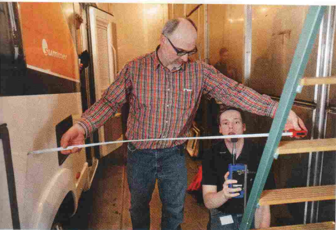
Die Klimaanlagegeräusche können auch den Stellplatznachbarn stören. Darum wurde zusätzlich außen in einem Meter Abstand gemessen.
