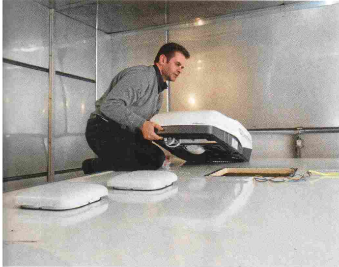
Servicetechniker der beiden Marken installierten jeweils ihre Anlage fachgerecht auf dem Dach des Testfahrzeugs.
