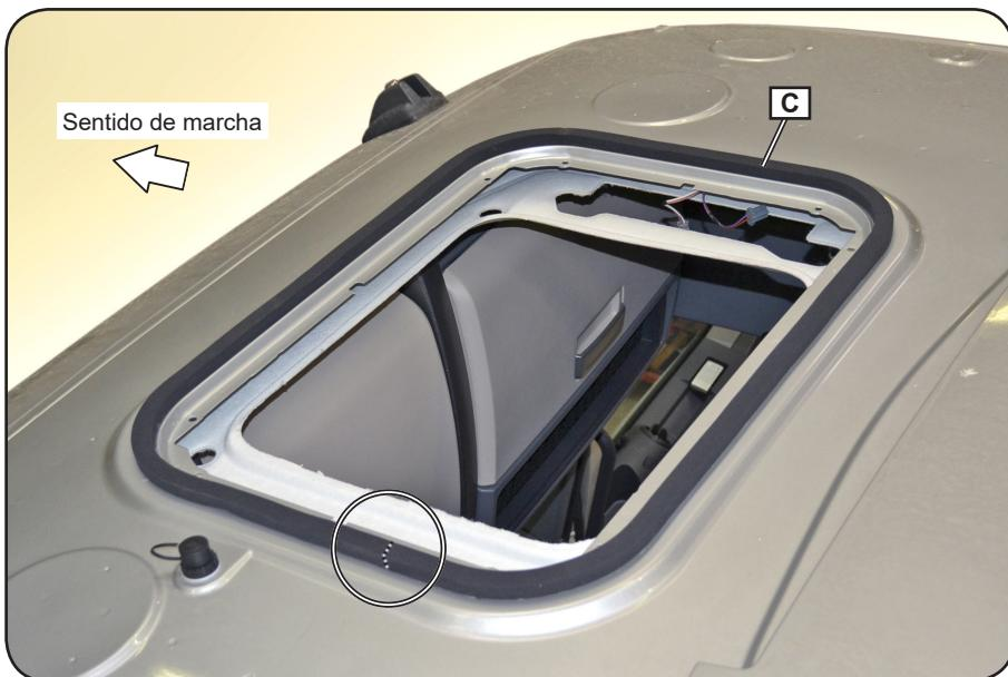
Completar el sellado de la junta.
