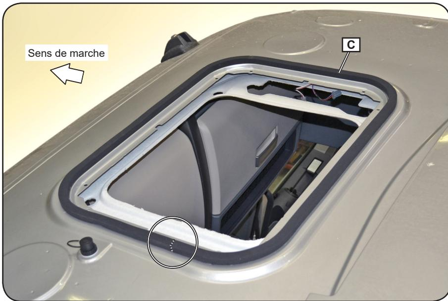
Compléter l'étanchéité du joint.
