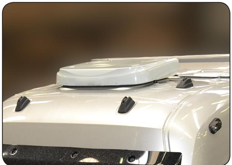
Die Klimaanlage mit den Bügeln **B** befestigen: die Enden der Bügel unter der Verkleidung anbringen, so dass sie auf den metallischen Teilen Halt finden; die Schrauben **CC** mit den Scheiben **DD** und den Muttern **EE** einsetzen und in den Gewindegussbuchsen am Boden der Klimaanlagen verschrauben. Auf Spannung bringen und die Muttern **EE** auf den Bügeln **B** anziehen.
