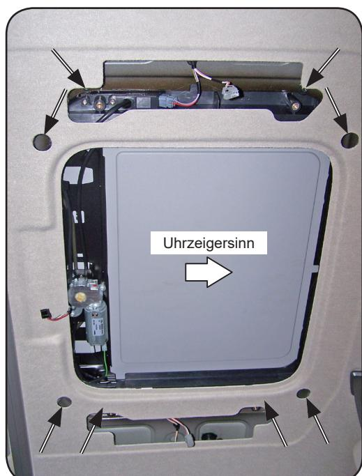
Den Umriss der Öffnung der Luke, dort wo die Dichtung der Klimaanlage aufliegen wird, mit Dichtmaterial bestreichen.
