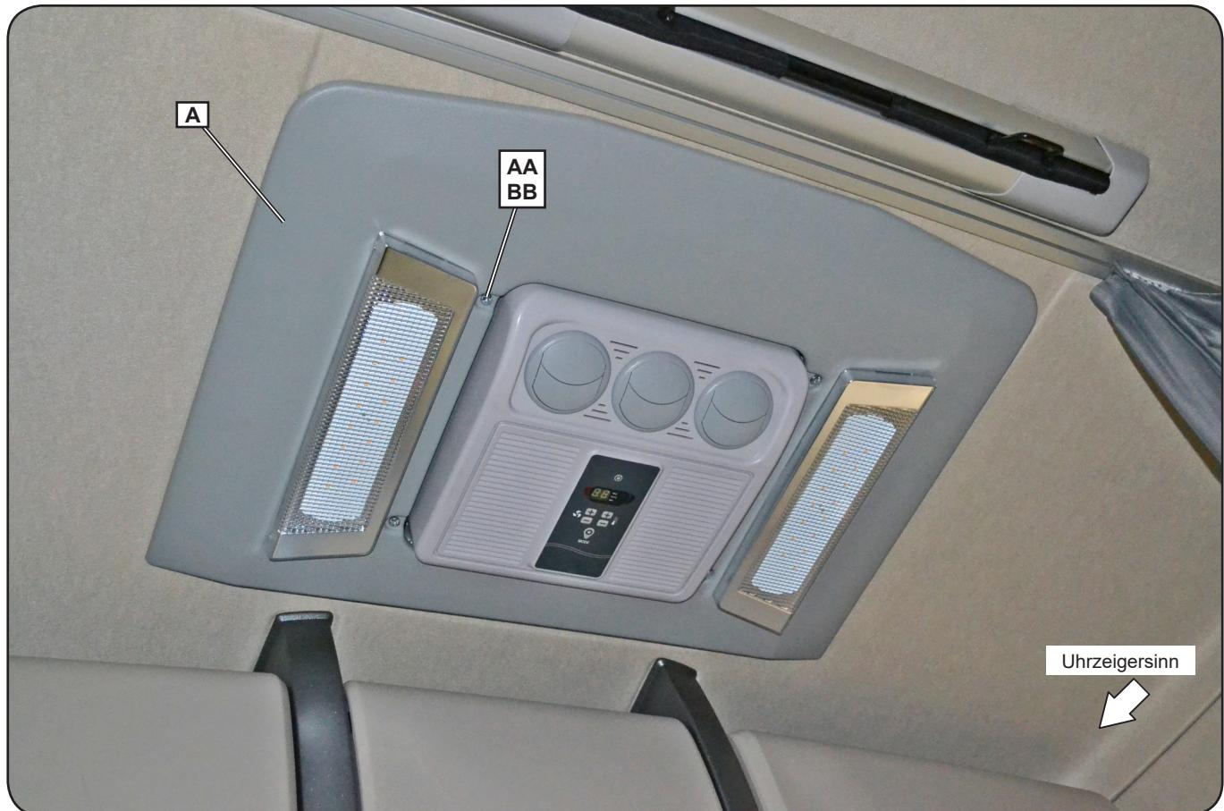
Die Beleuchtungskörper am neuen Rahmen montieren.
