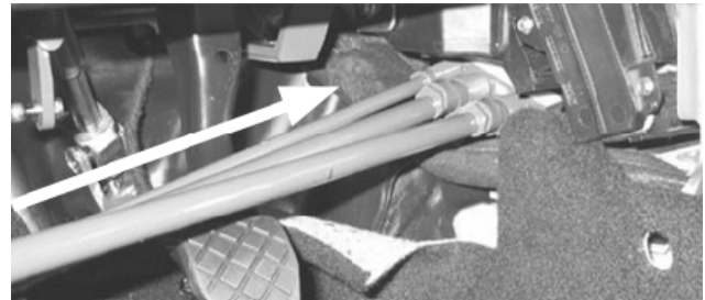
Kuva 5-28: Opetuspolkimiston runko-osan työntäminen paikalleen
