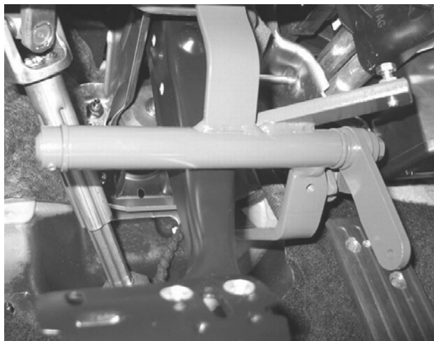
Kuva 5-21: Vasemman kiinnitystuen asettaminen paikalleen
