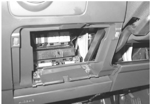
Kuva 5-5: Auki kääntyvä säilytyslokerokero irrotettuna
