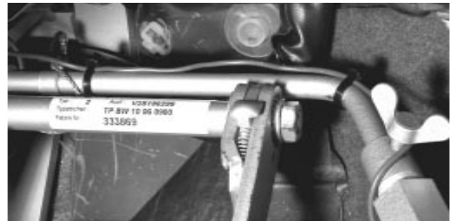
Bild 6-2: Befestigung des Kabels am Gaspedal
