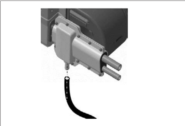
Fig. 6 Tubo de drenaje
