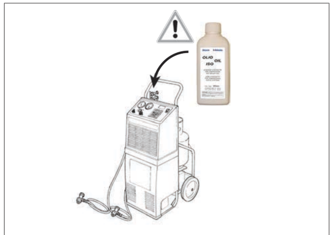
Abb. 8 Korrekte Schmiermittelmenge zugeben
