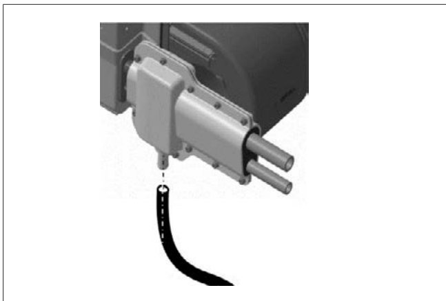
Fig. 6 Tubo di scarico
